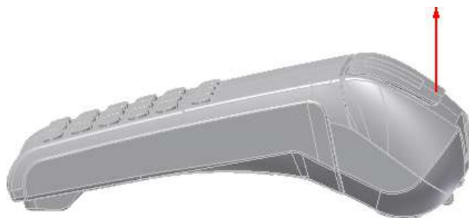
Рис.4 Открытие крышки отсека принтера
